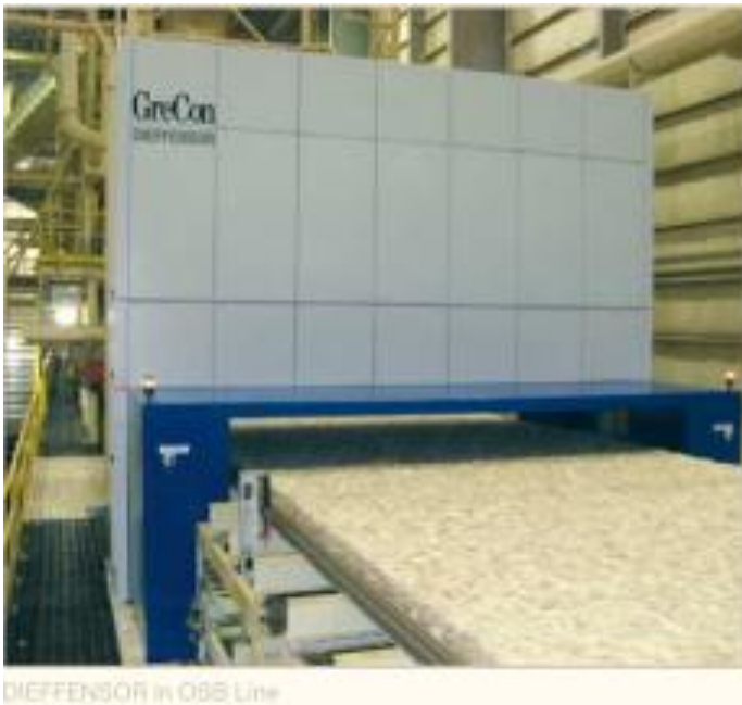
OSB 製造ラインにおけるディフェンザー
