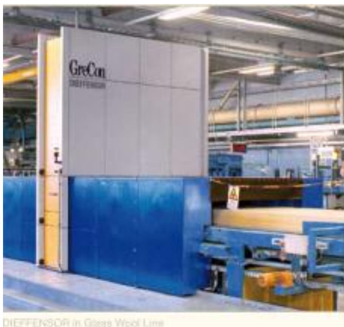
グラスウール製造ラインにおけるディフェンザー
